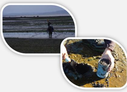
Figura 2. Extracción de muestras de sedimentos a diferentes niveles del intermareal.
